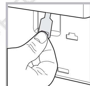
4. потяните наружу язычок, показанный на схеме, вплоть до освобождения пластикового блокировочного винта. Затем потяните его вниз и одновременно откройте люк.
